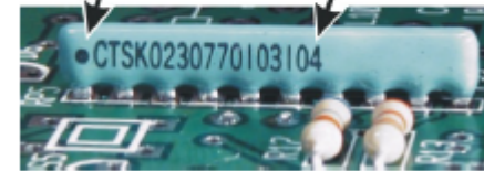
Bild 4 Installation Widerstand Array
